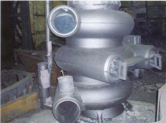
Bild 16. Gussknoten nach der Fertigung mit Anguss Fig. 16. Cast knot after the production
